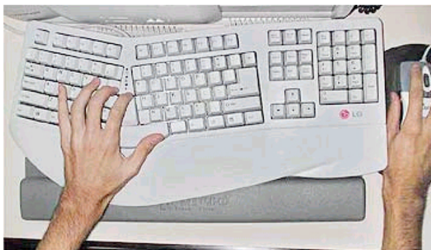
Figura 1: teclado ergonômico, projetado para ajustar-se à forma da mão do usuário
